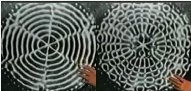
La lámina amplifica las vibraciones del oscilador. Las diferentes sustancias se concentran en las líneas nodales de las ondas sonoras, es decir, aquellos puntos donde no existe la oscilación, destacando de este modo el patrón negativo, o inverso, de las vibraciones resonantes de la placa.
