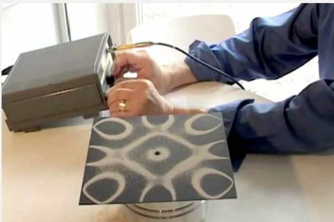
Dispositivo cimático conectado a un dispositivo electrónico generador de oscilaciones sinusoidales.
