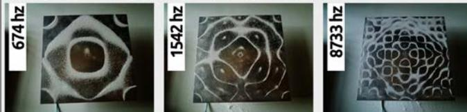
En los *puntos singulares frecuenciales* 674 / 1542 / 8733 se describen unas geometrías donde de manera recurrente aparece un romboide perimetral, y un cuadrado con los ángulos redondeados en el núcleo central.
