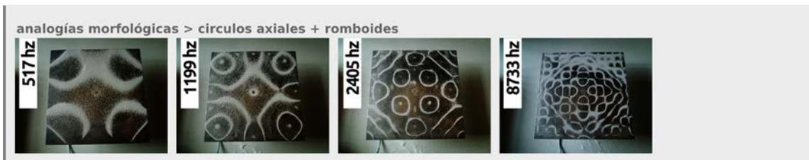
En los *puntos singulares frecuenciales* 517 / 1199 / 2405 / 8733 se encuentran unos patrones que describen la **formación de círculos axiales situados en los vértices de la placa** del dispositivo cimático, **así como unas siluetas romboidales de geometría regular** (por lo tanto cuadrados a 45°). Obsérvese que las frecuencias en la muestra central 1199/2405 son casi proporcionales (generando un grupo armónico) ( $1199 \times 2 > 2398 \text{hz} > \pm 2405 \text{hz}$ ).
