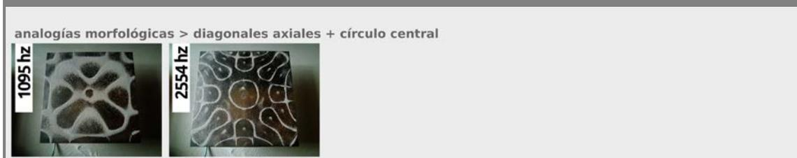
En los *puntos singulares frecuenciales* 1095 / 2554 se describen **figuras con una marcada axialidad diagonal** (a 45°). En ambas se describe un **círculo central**.
